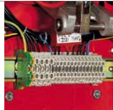
P 140-200-300-450 P/G型 燃烧器电气连接 接线端子板示例
