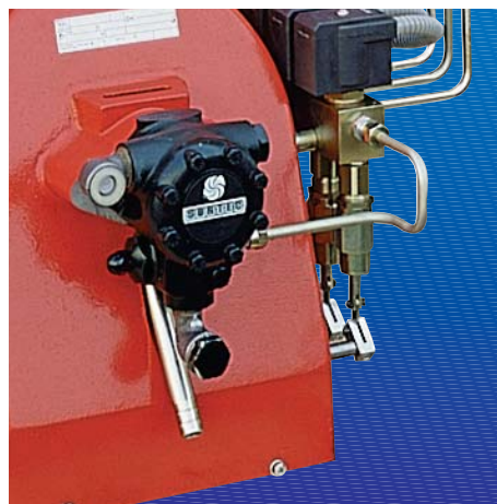
PRESS 200 T/G 型燃烧器液压回路示例
